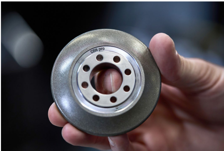
Bild 4: Mit CBN pro, den neuen Werkzeugen von KAPP NILES, können Oberflächengüten von Ra < 0,2 \mu m am Werkstück erreicht werden.
